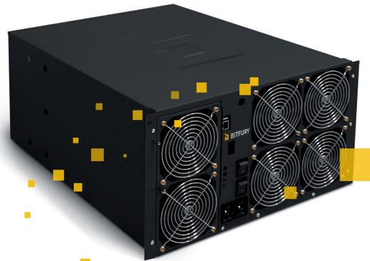
Bitfury Tardis は、5 ~ 8 枚のハッシュボードを搭載でき、各ボードにはフルカスタムの最新 128 Bitfury Clarke ASIC チップが内蔵されており、電源効率を重視した構成から TH あたりの価格を抑えた構成まで幅広く対応できます。
